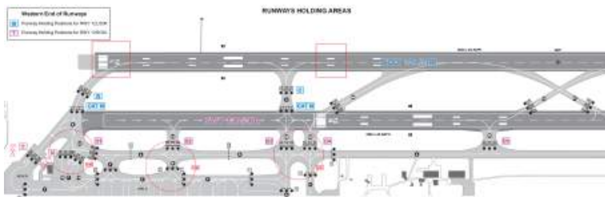
Слика П7-1. План аеродрома са приказом позиције за полетање са скраћеним залетом преко TWY C и пуне дужине полетања са прага RWY12
